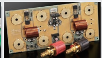
Baugruppe mit Schutzschaltungen
