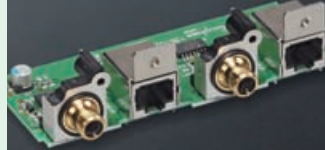
Platine mit Anschlüssen für externe Signalverarbeitung
