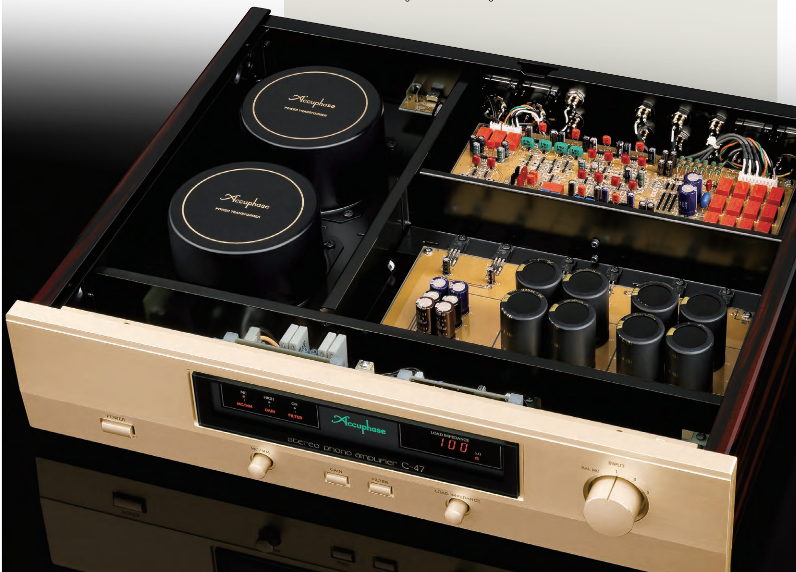
Internes Layout verwirklicht konsequenten Mono-Aufbau zur Verhinderung von Wechselwirkungen zwischen Kanälen
