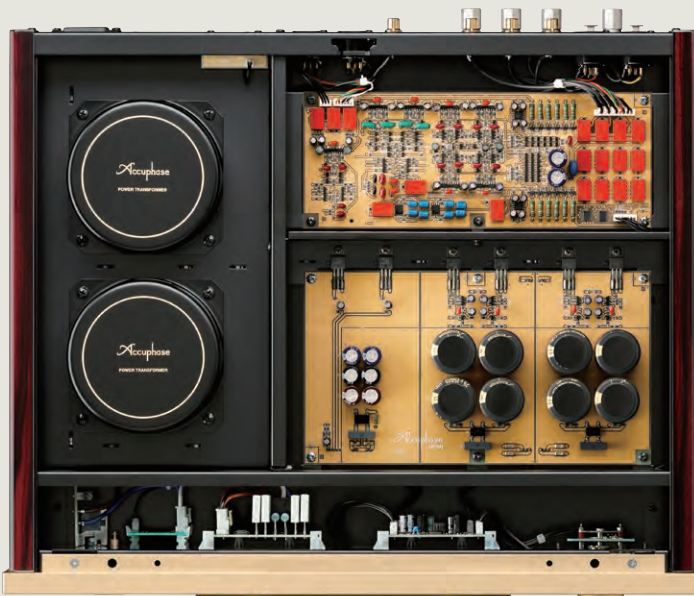
Internes Layout verwirklicht konsequenten Mono-Aufbau zur Verhinderung von Wechselwirkungen zwischen Kanälen
